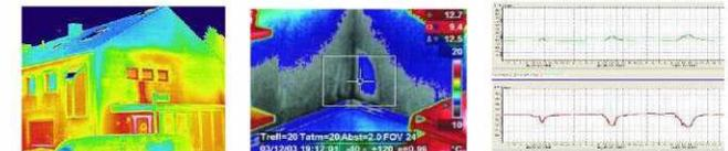
Diese Frage kann mit Hilfe unserer Thermokamera meist sehr schnell beantwortet werden. Um ein Ergebnis zu erhalten werden für das Gutachten normale Fotos sowie Thermografieaufnahmen vom entsprechenden Objekt erstellt. Dazu wird die Temperatur und die relative Feuchte im betreffenden Raum gemessen und die Daten ausgewertet.
